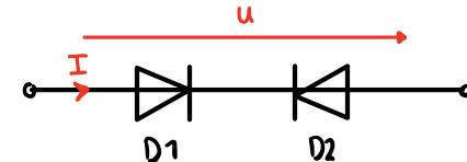
=> la caractéristique  $U_2(I)$  doit être prise avec une rotation de 180°.
